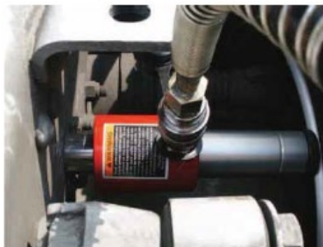
Teherautó gumibroncs levétele a kerékagyról mini-préssel. A feszítő befér az alváz és a kerék közé.
