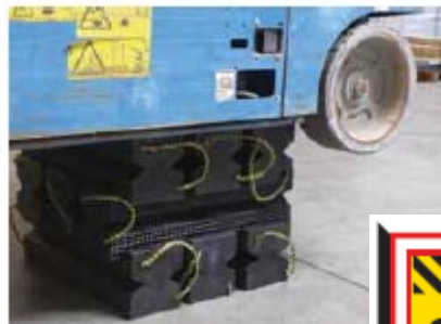
A kitámasztó tömbök egymásba kapcsolódó rendszerben lettek kialakítva.
