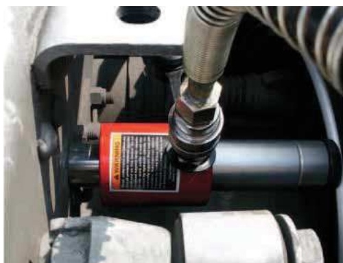
▲ Teherautó gumiabroncs levétele a kerékagyról mini-préssel. A feszítő befér az alváz és a kerék közé.
